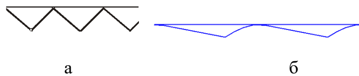
Рис. 3.7. Схема мікронерівностей поверхні після операцій точіння
